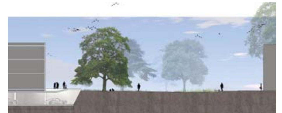
coupe en travers de la prairie centrale penté de façon à récolter les eaux de pluie
