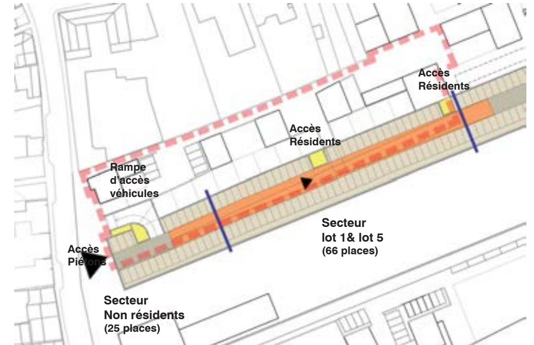
Parking souterrain sectorisé
